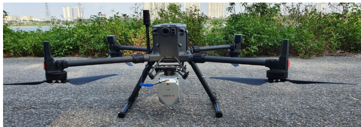
Hình 4: Lắp đặt AA450 trên DJI M300
