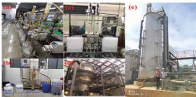
▲ Hình 3. Hệ thống FBR lắp đặt quy mô (a) 0,5; (b) 5,0; (c) 10; (d) 1000 và (e) 10.000 m 3 /ngày, đêm (Nguồn: Lê Văn Giang, 2022)
