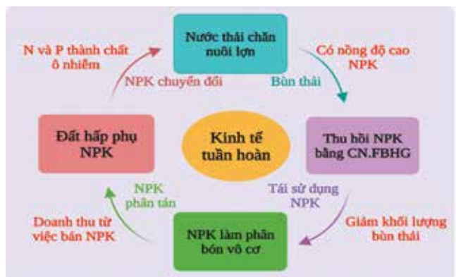
▲ Hình 4. Mô hình kinh tế tuần hoàn cho thu hồi NPK và tái sử dụng làm phân bón (Nguồn: Lê Văn Giang, 2022)
