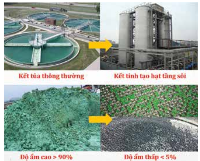
▲ Hình 1. So sánh công nghệ kết tinh và công nghệ tạo hạt tầng sôi (Nguồn: Lê Văn Giang, 2022)
