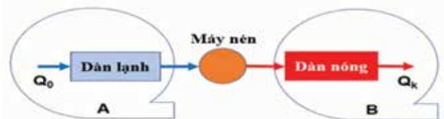
▲ Hình 2. Sơ đồ nguyên lý làm lạnh cơ bản chu trình lạnh A - Môi trường cần làm lạnh; B - Môi trường không khí bên ngoài; Q 0 - Nhiệt lượng gas lạnh nhận được ở môi trường cần làm lạnh qua dàn lạnh; Q k - Nhiệt lượng gas lạnh thải ra môi trường bên ngoài qua dàn nóng
