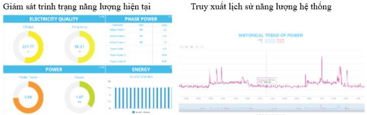
Hình 4. Ví dụ về giao diện giám sát của hệ thống điện thông minh dựa trên công nghệ IoT
