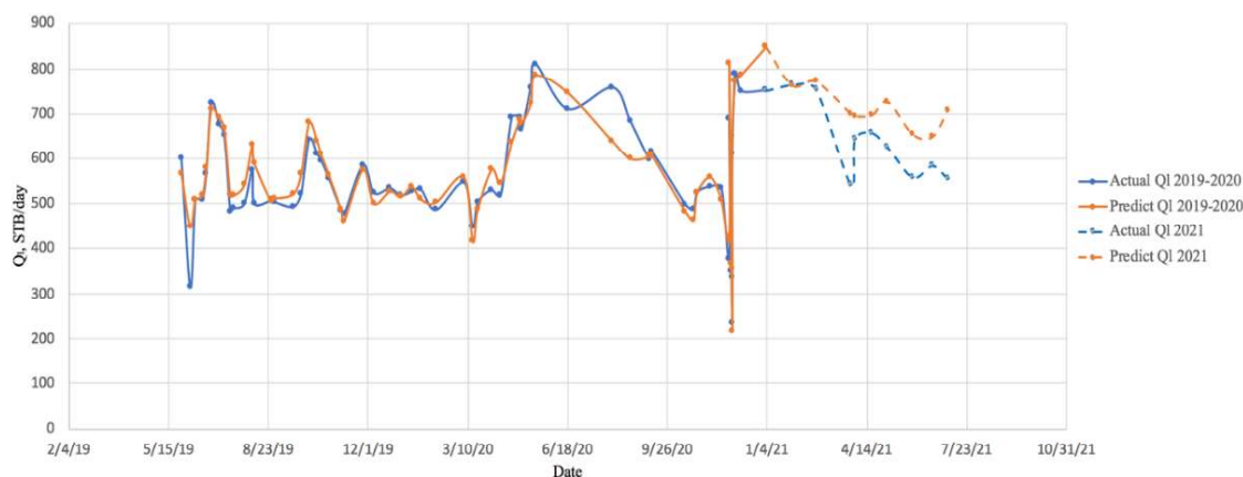
Рисунок 2. Сравнение прогнозного дебита по модели ИНС и фактических данных по скважине №5 за 2 периода эксплуатации (2019–2020 и 2021)
