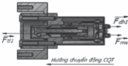
Hình 2. Các lực tác dụng lên CQT khi gia tốc tên lửa tăng đến mở bảo hiểm lần 1.
