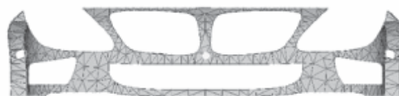
Hình 1. Mô hình BDS I cổng phun trong Moldflow
