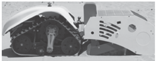
Hình 6. Máy làm sạch bãi biển Bebot
