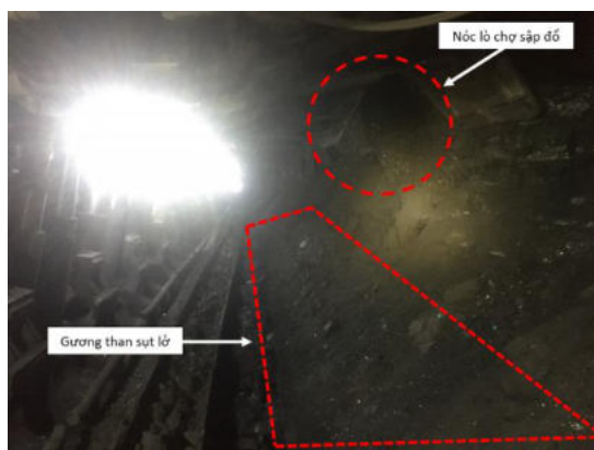
Hình 2. Tụt lở than lò chợ cơ giới hóa mỏ than Hà Lâm
