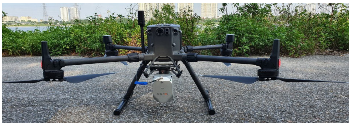
Hình 4: Lắp đặt AA450 trên DJI M300
