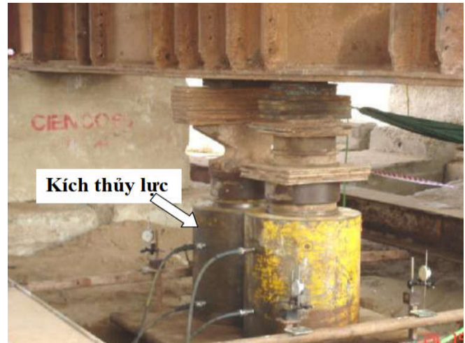
Hình 2: Minh họa thiết bị đo lực và đồng hồ chuyển vị thí nghiệm nén tĩnh cọc
