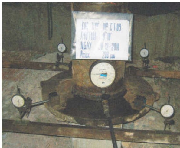
Hình 2: Minh họa thiết bị đo lực và đồng hồ chuyển vị thí nghiệm nén tĩnh cọc
