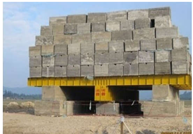
Hình 1: Hiện trường gia tải thí nghiệm nén tĩnh cọc
