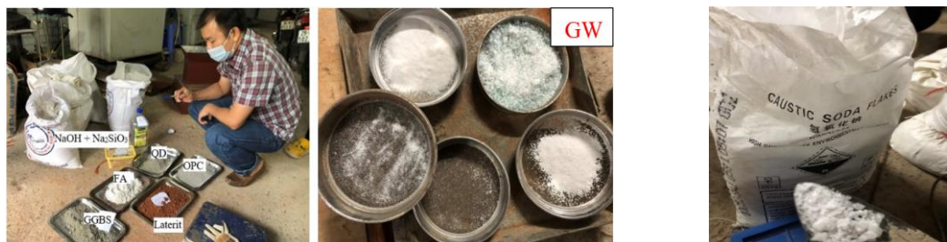
(a) Một số vật liệu AluminoSilicate: tro bay (FA), xi lò cao nghiền mịn (GGBS), bột thủy tinh nghiền (GW)
