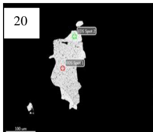
Ảnh 20. Mẫu LK22.KT5-002-Biểu đồ biểu diễn thành phần nguyên tố và giá trị % kết quả. chụp dưới kính hiển vi điện tử quét (SEM)-Trung tâm PT công nghệ cao- Trường ĐH Mô-Địa chất.
