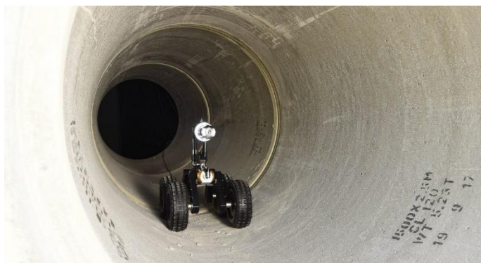
Hình 2 Thiết bị thăm dò hiện trạng đường ống bằng CCTV [2]
