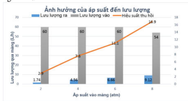
Hình 3-1. Năng suất lọc của hệ thống màng
