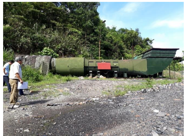
Hình 12. Mặt bằng bố trí và hình dạng chung của trạm quạt FBDCZ - II - N 0 18 Khu Bắc Mông Dương
