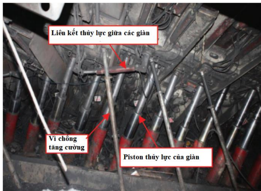
a. Chống giữ lò chợ với giàn chống model HPG
