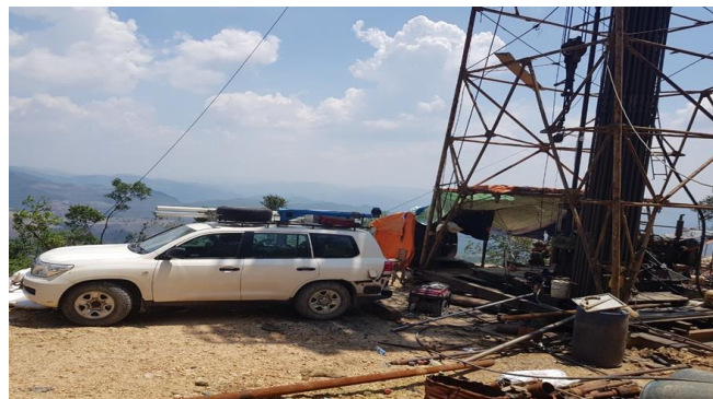
Hình 3. Trạm đo Địa vật lý Roberson Geologging đang tiến hành đo ngoài thực địa
