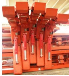
a. Cấu tạo giàn chống 1 - Xà dẫn hướng; 2 - Xà nóc (xà chính); 3 - Xà che chắn; 4 - Xà đuôi; 5 - Piston điều khiển xà đuôi
