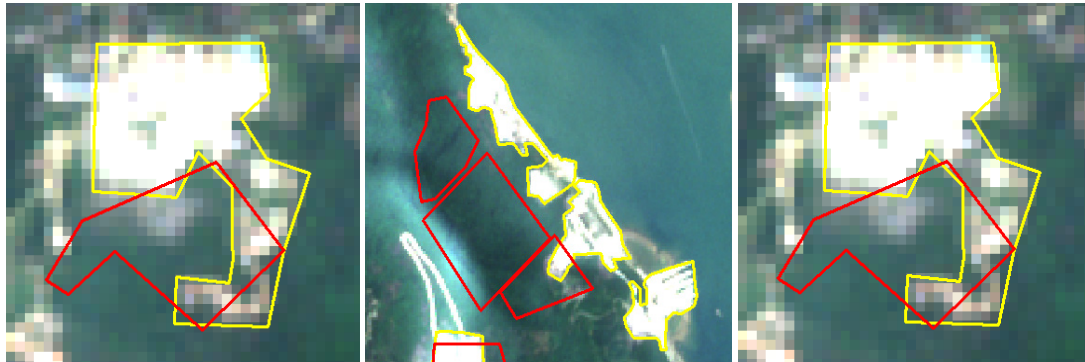
Hình 6: Minh họa các vùng KTKS ngoài vùng cấp phép (giữa), rộng hơn vùng cấp phép (trái), diện tích không đúng cấp phép (phải)
