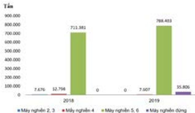
Hình 6: Tổng lượng phát thải CO 2 với các loại máy nghiền trong sản xuất xi măng PCP40
