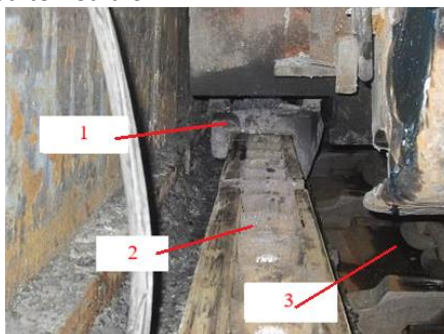
Hình 2. Tương quan vị trí gối trượt dẫn hướng và ghim ray
