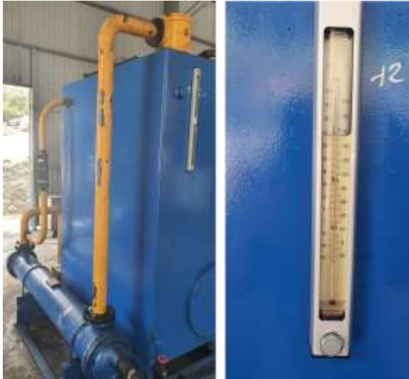
Hình 4. Thiết bị làm mát dầu và nhiệt độ dầu thủy lực 35°C khi nhiệt độ môi trường 27°C.
