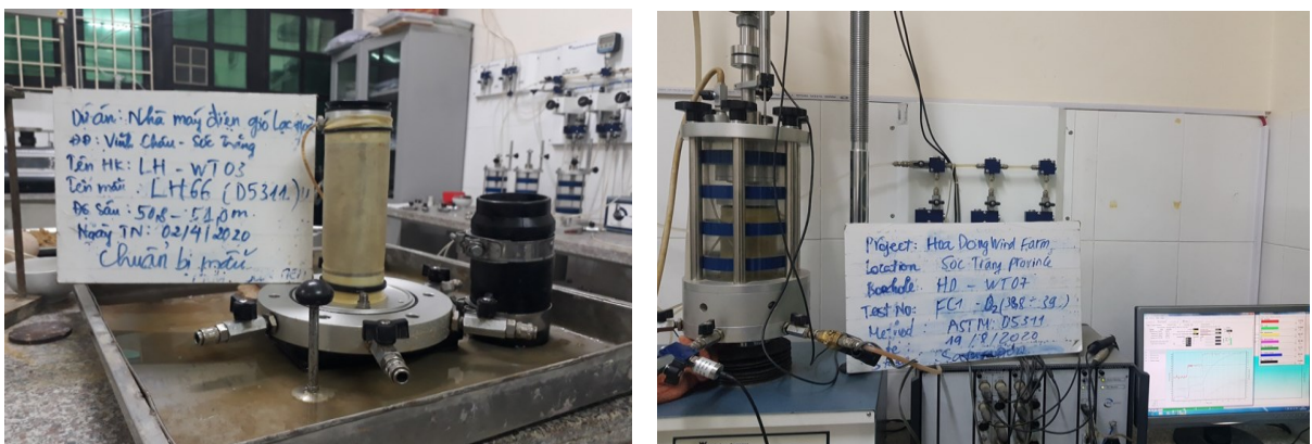
Hình 3. Lắp đặt mẫu vào buồng áp lực
