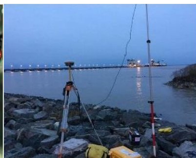
Khảo sát bồi lắng NMNĐ Duyên Hải bằng máy định vị vệ tinh Trimble R8s
