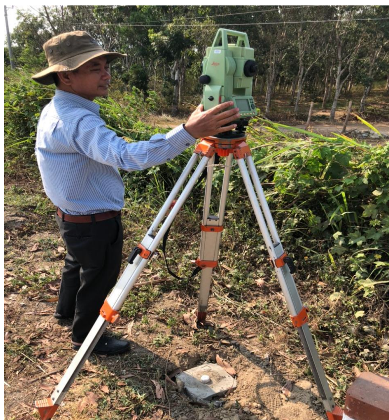
Hình 4. Đo chi tiết bằng máy toàn đạc điện tử tại điểm khống chế đo vẽ Tọa độ của 06 điểm khống chế đo vẽ được cho trong bảng 1:
