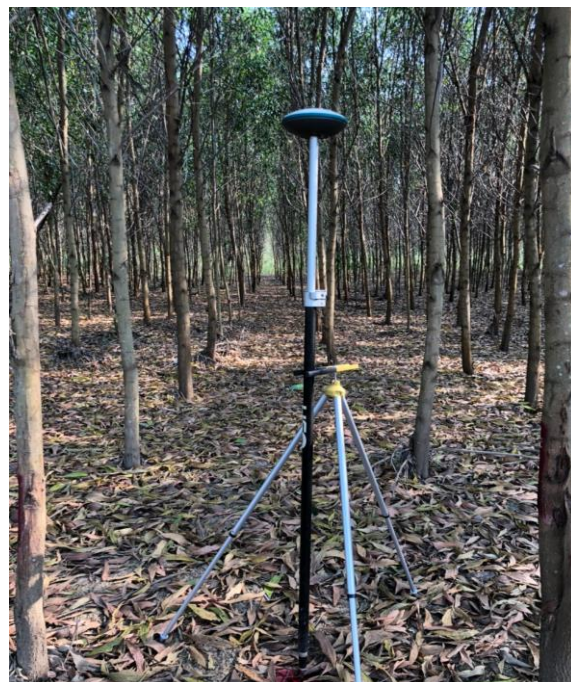
Hình 3. Đo chi tiết bằng RTK dưới tán cây keo lá trà
