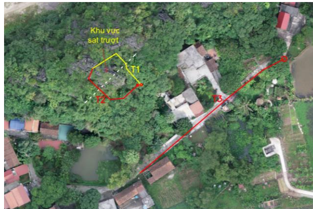
Hình 5. Vị trí tuyến đo địa chấn xác định mặt trượt tại Núi Vườn Già
