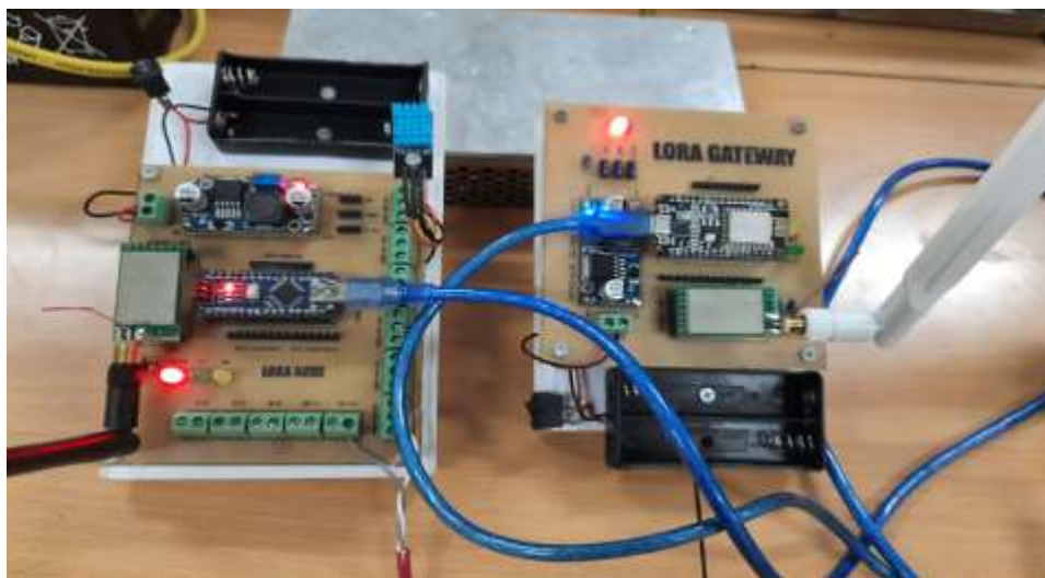
Hình 1. Các module lora được sử dụng để triển khai thuật toán AES 128bit (Đề tài CT2019.01.04)
