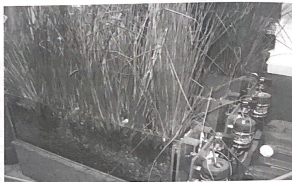
Hình 2. Hệ thống CWs qui mô phòng thí nghiệm
