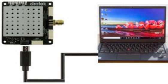
Hình 3. Kết nối để cài đặt cấu hình cho module GNSS ZED - F9P.
