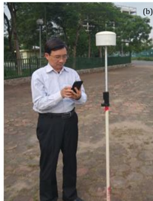
Hình 8. Đo thực nghiệm đánh giá độ chính xác của máy KX20-R. (a) Đo bằng máy S82; (b) Đo bằng máy KX20-R.
