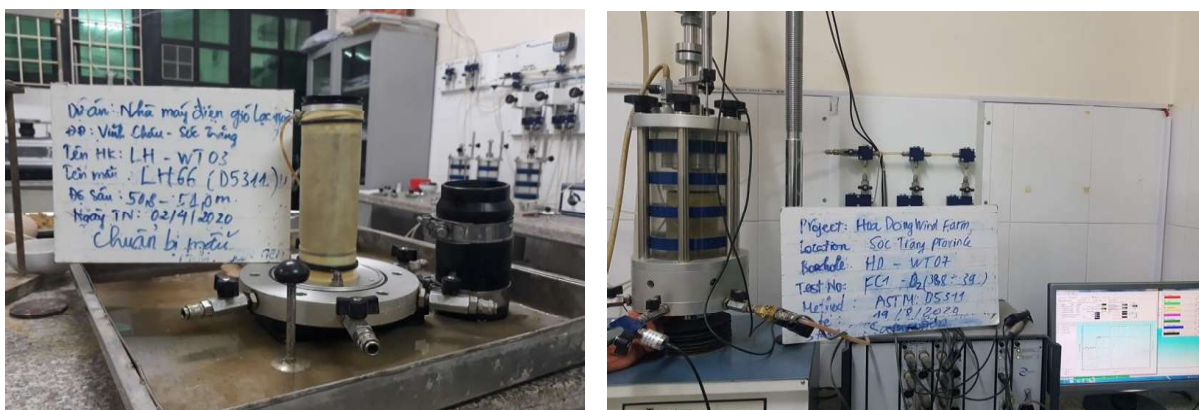
Hình 3. Lắp đặt mẫu vào buồng áp lực
