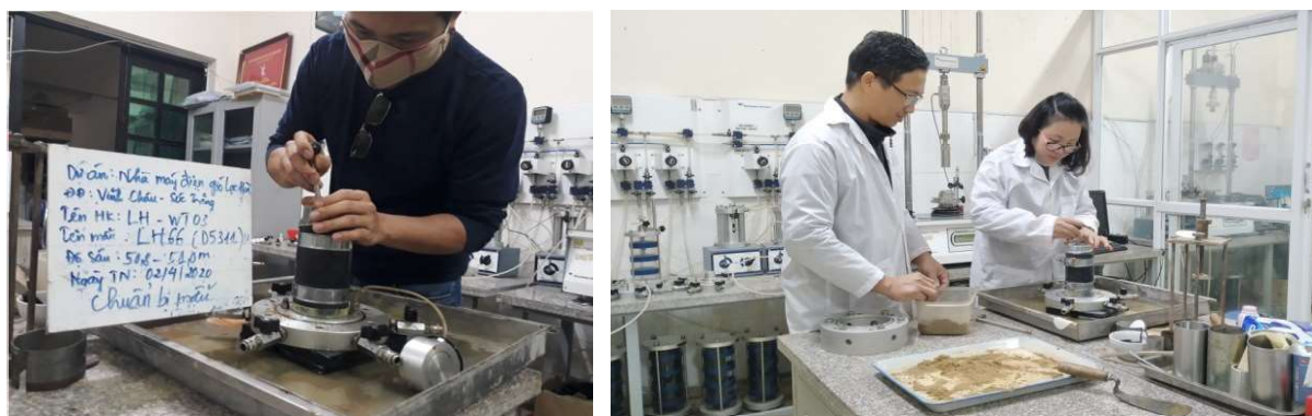
Hình 2. Công đoạn chế bị mẫu đất rời
