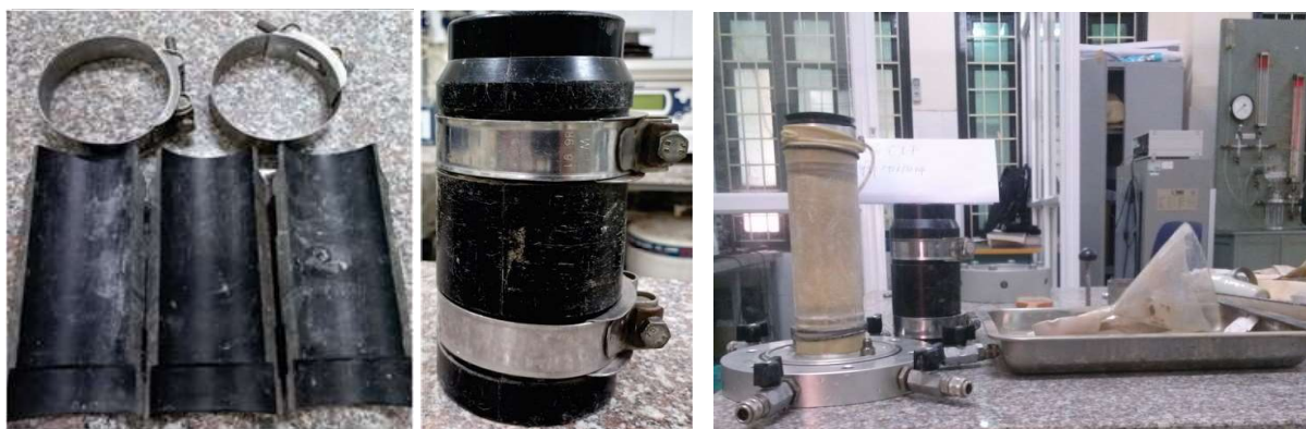
Hình 1. Khuôn và dụng cụ dùng cho chế bị mẫu đất rời
