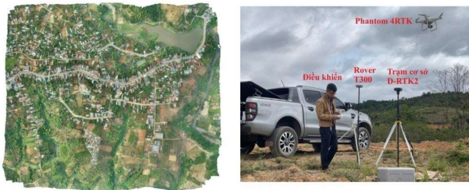
Hình 2. Vùng nghiên cứu và thiết bị bay thu nhận ảnh chụp (ảnh Trần Trường Sinh)
