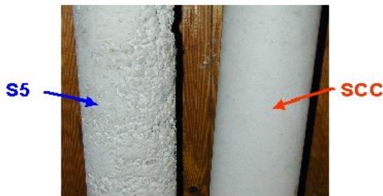
Hình 1. Bề mặt của bê tông truyền thống S5 và bê tông tự đầm SCC (Hajime Okamura, Masahiro Ouchi, 2003).
