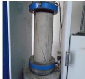
Hình 14. Nén mẫu trong phòng thí nghiệm.
