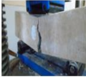
Hình 17. Dầm bê tông xi thép bị gãy.
