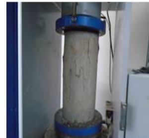
Hình 14. Nén mẫu trong phòng thí nghiệm.
