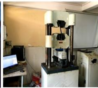
Hình 16. Máy uốn dầm của hãng Controls.
