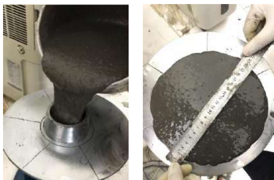
Рис. 1. Определение удобоукладываемости мелкозернистых бетонных смесей по расплыву конуса
