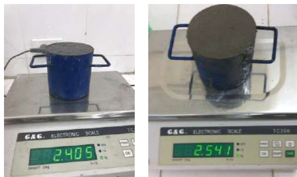
Рис. 2. Определение плотности мелкозернистых бетонных смесей
