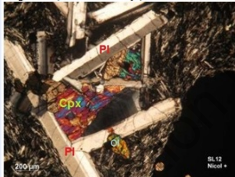
(C) Mẫu SL12. Trachyandesit, kiến trúc tụ ban tinh gồm plagioclas (Pl), pyroxen (Cpx), olivin (Ol), nền thủy tinh.
