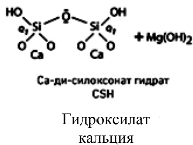
Рис. 3. Первый этап реакции ЗУ и ЗРШ со щелочами, расщепление акерманита
