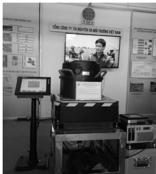
Hình 3. Hệ thống chụp ảnh & quét LiDAR hàng không CityMapper
