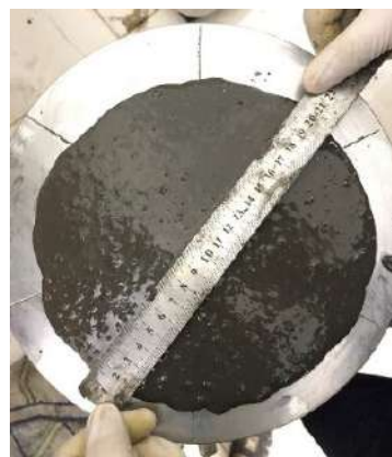
Рисунок 2. Определение удобоукладываемости геополимерных бетонных смесей по расплыву конуса
