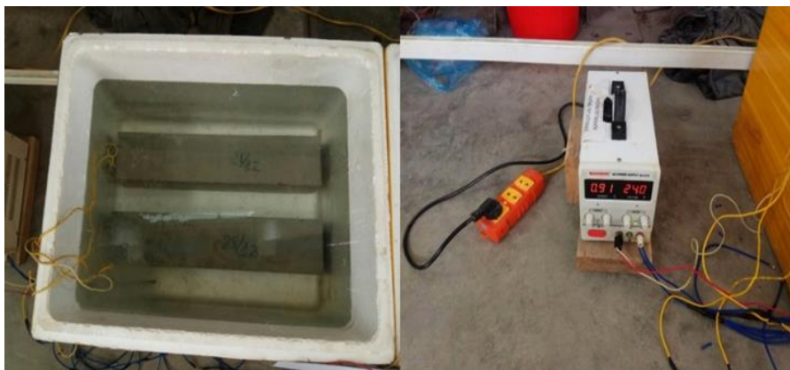
Hình 6. Mẫu đầm ngâm trong môi trường ăn mòn điện tiến nhanh không gia tải
