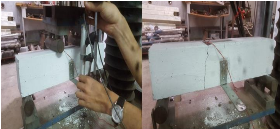
Hình 5. Hình ảnh thực nghiệm uốn đầm xác định P max
