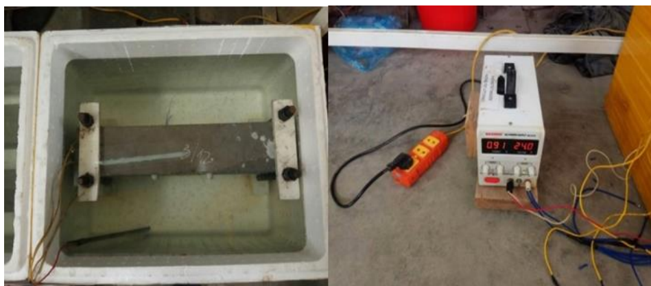
Hình 7. Mẫu dầm ngâm trong môi trường ăn mòn điện phân có gia tải
