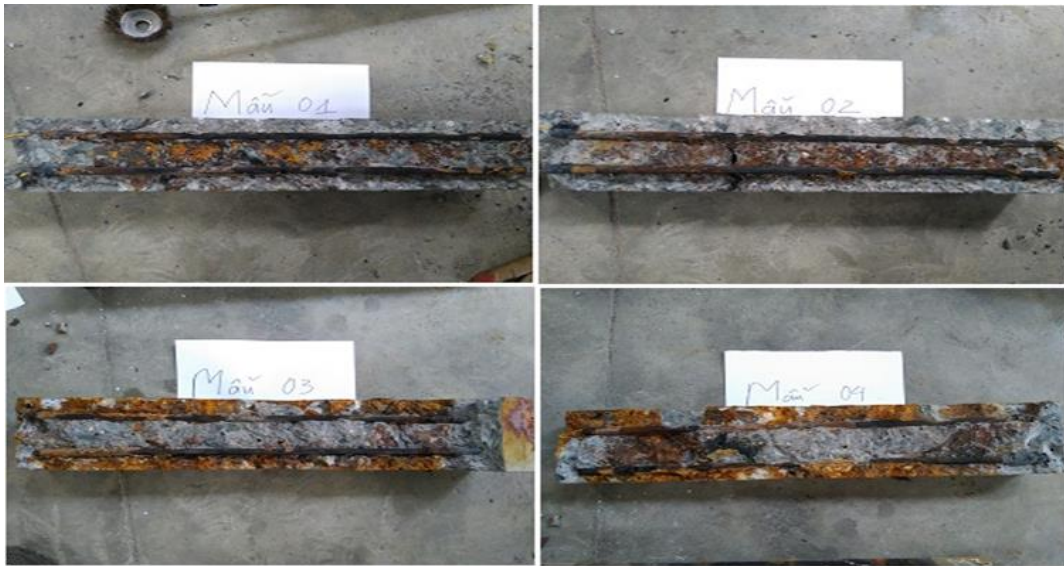
Hình 8. Hình ảnh cốt thép các tổ hợp dầm bị ăn mòn sau khi ngâm
