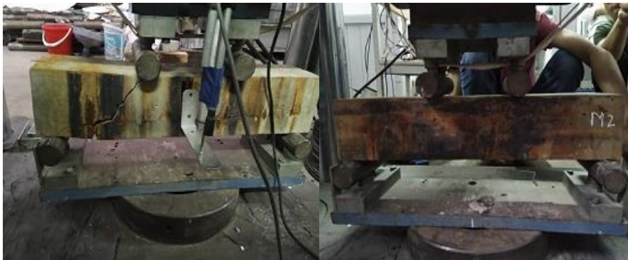
Hình 10. Tiến hành uốn 4 điểm đối với các mẫu dầm sau khi ngâm 30 ngày
