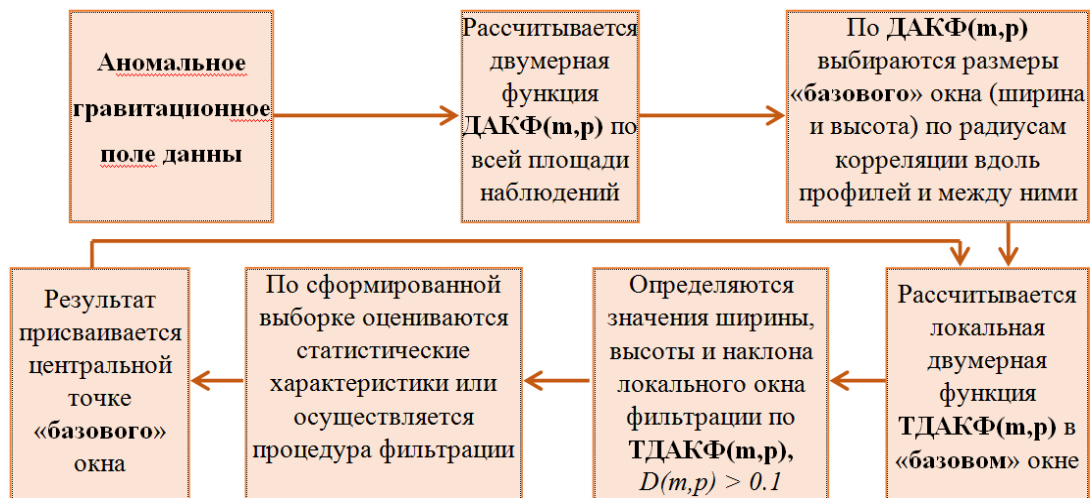
Рисунок 2. Схема алгоритма двумерного фильтра в скользящих окнах «живой» формы
