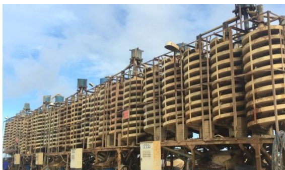
Hình 2. Hệ thống bè vít xoắn tuyển thô tại mỏ titan Cương Gián, Hà Tĩnh
