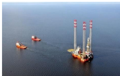
Hình 2. Giàn khoan tự nâng được kéo bởi 2 tàu lai dắt
