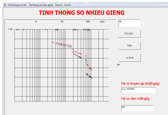
Hình 3. Đồ thị mực nước hạ thấp thực đo và tính toán với các thông số hệ số dẫn nước T = 500 m^2/ngày , hệ số truyền áp a = 1010000 m^2/ngày
