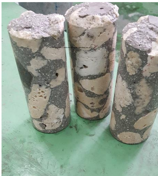
Hình 4. Thí nghiệm thấm mẫu: cát san hô - xi măng; cành nhánh, cát san hô - xi măng Kết quả mẫu xi măng san hô dạng cành nhánh sau khi gia cố:
