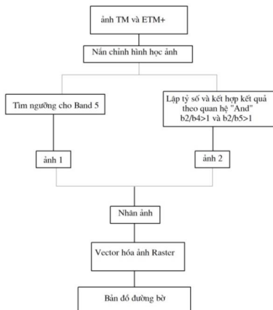
Hình 2. Quy trình thực hiện tách đường bờ biển bằng phương pháp tỷ số ảnh
