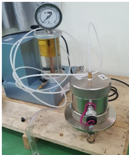
Hình 4. Thí nghiệm thấm mẫu: cát san hô - xi măng; cành nhánh, cát san hô - xi măng Kết quả mẫu xi măng san hô dạng cành nhánh sau khi gia cố:
