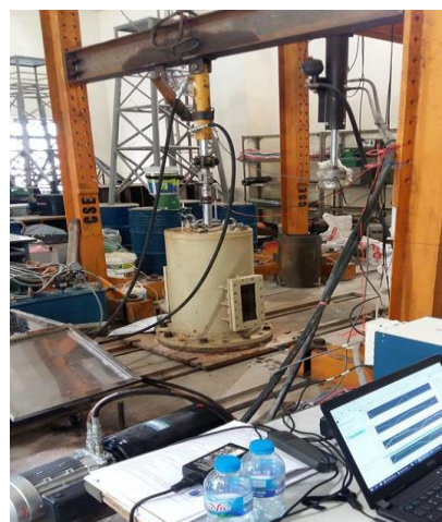
Hình 2. Thí nghiệm ba trục cỡ lớn
