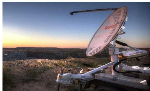
Hình 19. Trạm SSR được sử dụng để quét bờ mỏ (Nguyễn Viết Nghĩa và nnk., 2017).
