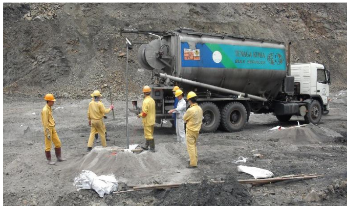
Hình 13. Xe chuyên dụng cơ giới hóa trong vận chuyển, sản xuất, nạp nổ mìn trên mỏ lộ thiên.
