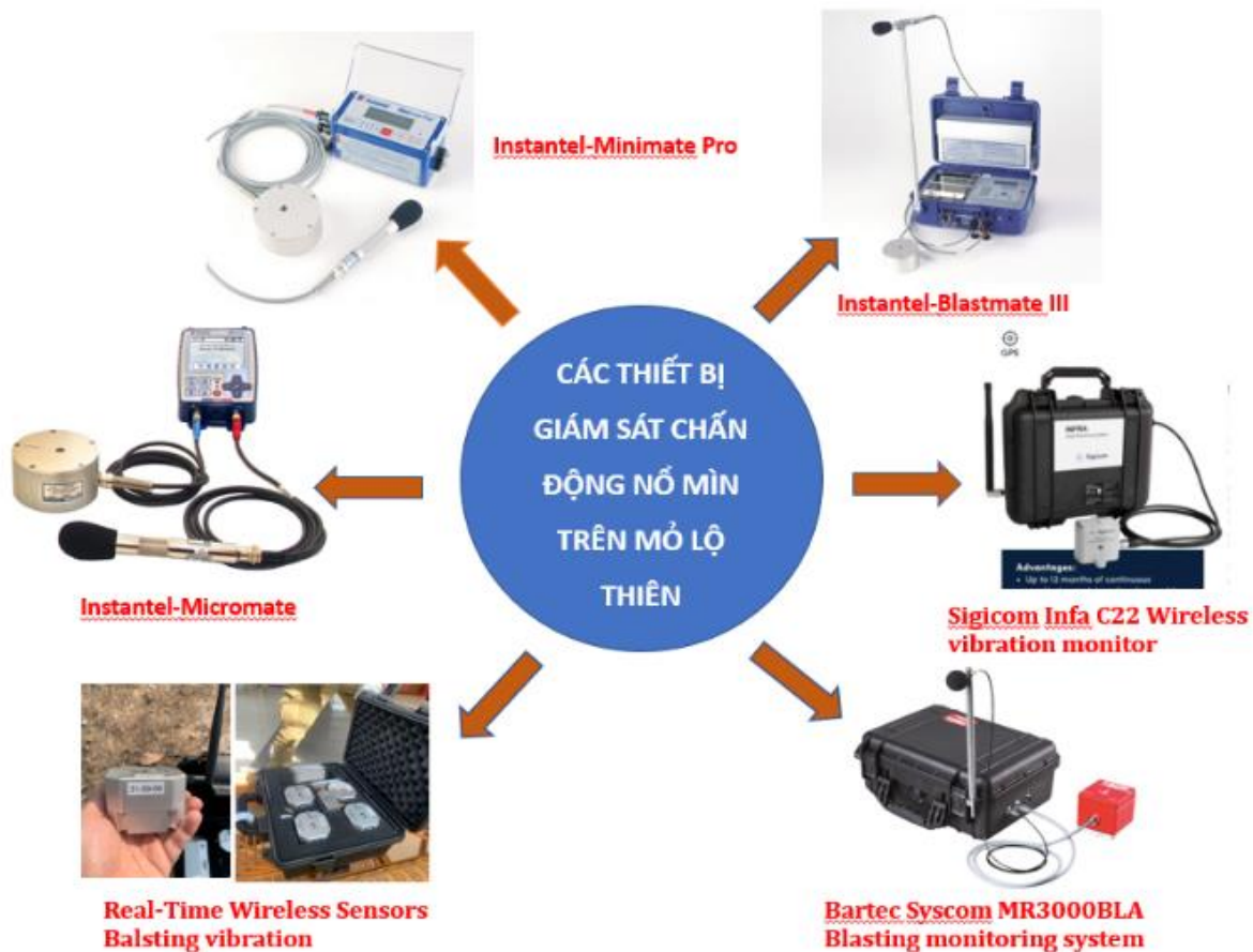
Hình 10. Các thiết bị giám sát chấn động nổ mìn hiện đại được áp dụng tại các mỏ lộ thiên.
