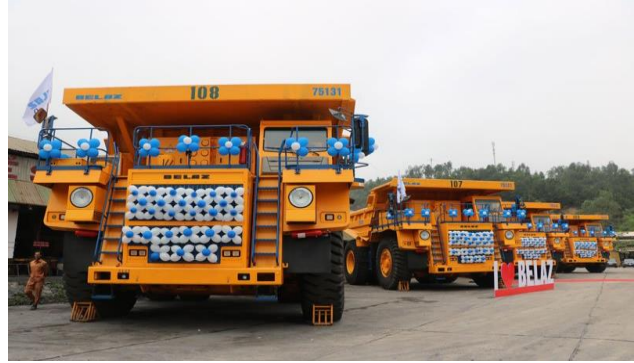
Hình 15. Xe tải BELAZ 75131 có tải trọng 130 tấn do Tập đoàn BELAZ - CH Belarus sản xuất.
