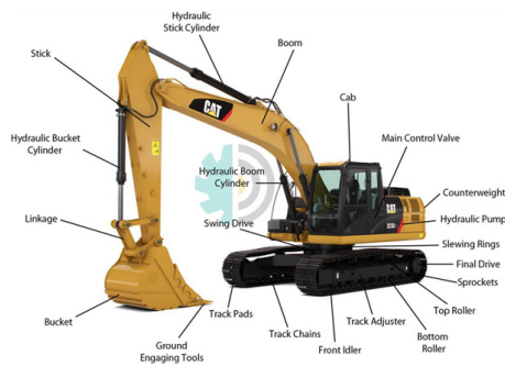
Fig. 1. Parts of hydraulic excavator Rys. 1. Części koparki hydraulicznej
