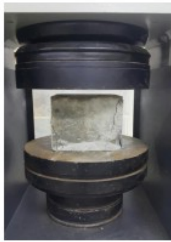
Hình 4. Mẫu BTXMTB hình lập phương bị phá hủy sau khi nén đơn trục (sử dụng thiết bị ADVANCEDTEST 9)
