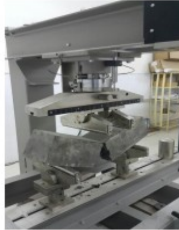
Hình 6. Mẫu BTXMTB bị phá hủy sau khi uốn đơn trục (sử dụng thiết bị ADVANCEDTEST 9)
