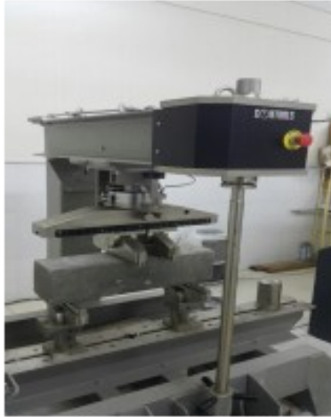
Hình 5. Mẫu BTXMTB trước khi uốn (sử dụng thiết bị ADVANCEDTEST 9)
