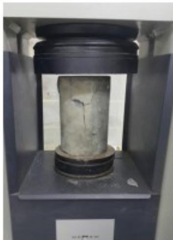
Hình 3. Mẫu BTXMTB hình trụ bị phá hủy sau khi nén đơn trục (sử dụng thiết bị ADVANCEDTEST 9)
