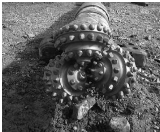
Hình 3. Đầu khoan có kết hợp với tia phun trong khoan ngang định hướng
