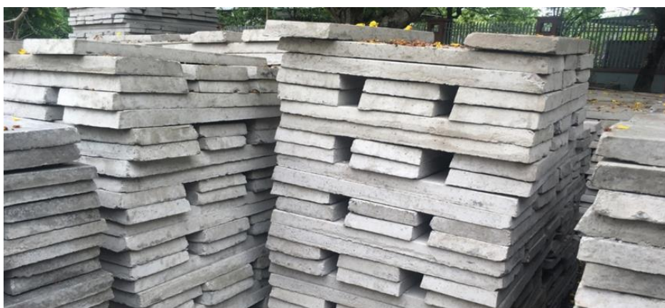
Hình 8. Bãi chứa tấm chèn sau khi chế tạo chuẩn bị đưa vào chống (Phạm Tuấn Anh và nmk, 2020)
