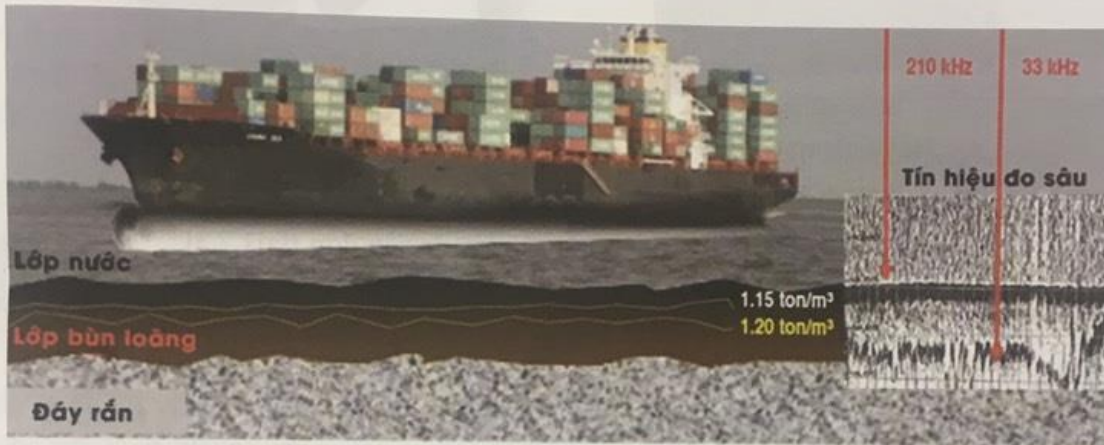
Hình 1: Độ sâu luồng được đo bằng thiết bị hồi âm đa tần (hình vẽ minh họa)
