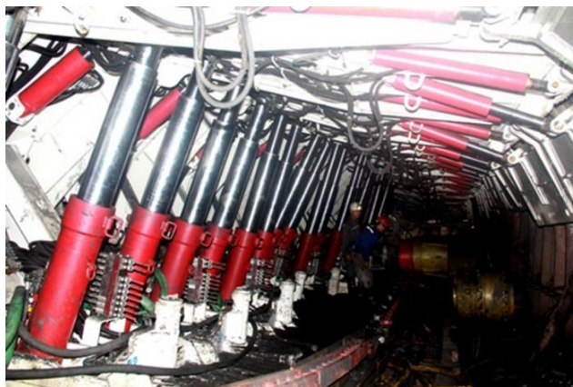
Hình 1. Giàn chống ZY3200/16/36 và máy khấu MG 300/700-W tại mỏ than Dương Huy (Tạp chí Năng lượng Việt Nam 2018)
