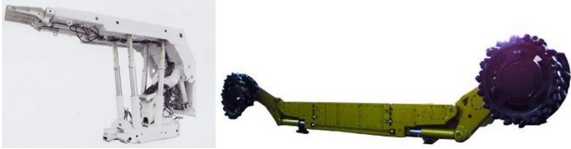
Hình 3. Giàn chống ZF4400/17/28 và máy khâu MG 170/410-WD tại mỏ than Vàng Danh (Le và Bui 2019)
