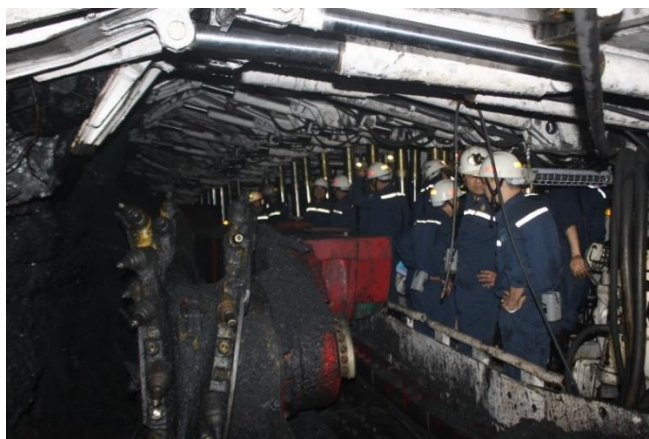
Hình 2. Giàn chống ZF4400/16/28 và máy khâu MG 150/375-W tại mỏ than Hà Lâm (Le và Bui 2019)
