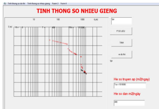
Hình 4. Đồ thị mực nước hạ thấp thực đo và tính toán với các thông số hệ số dẫn nước T = 400 m^2/ngày , hệ số truyền áp a = 1010000 m^2/ngày
