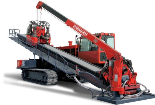
Hình 1. Thiết bị khoan ngang định hướng HDD
