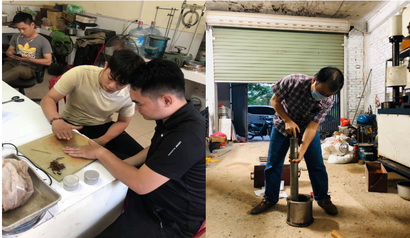
Hình 3. Thí nghiệm xác định giới hạn Atterberg và đầm nén tiêu chuẩn Proctor
