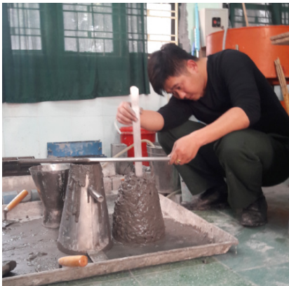
Hình 2. Chuẩn bị đúc mẫu và xác định độ sụt của bê tông
