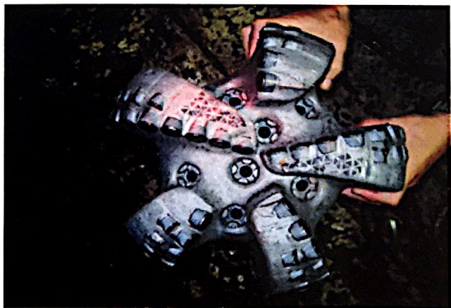
Рис.3. Долото PDC диаметром 311 мм использованное при бурении скважины №406.
