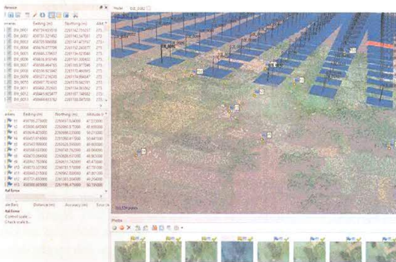
Hình 10: Định vị đám mây điểm theo hệ tọa độ bằng các điểm khống chế ảnh (Agisoft Photoscan)
