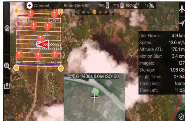
Hình 4. Sơ đồ tuyến bay được thiết kế trên phần mềm Map Pilot.
