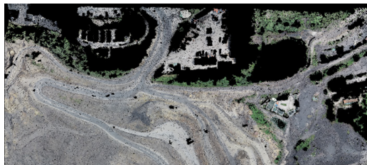
Fig. 9. Detected ground points after second ground routine in the Northside of the area (around our camp in figure 3) Rys. 9. Wykryte punkty naziemne po drugiej procedurze naziemnej w północnej części obszaru (wokół naszego obozu na rysunku 3)
