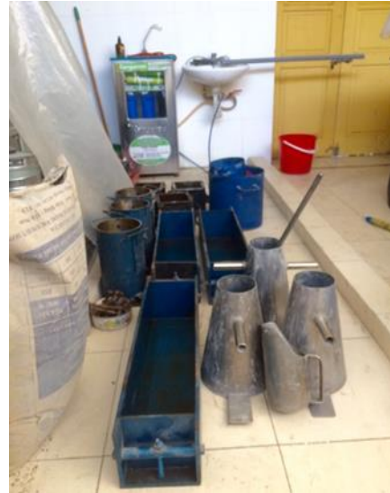
Hình 2. Chế tạo mẫu bê tông xi măng tro bay (BTXMTB)
