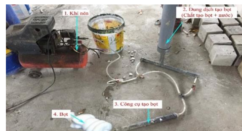
Hình 1. Quy trình tạo bọt
