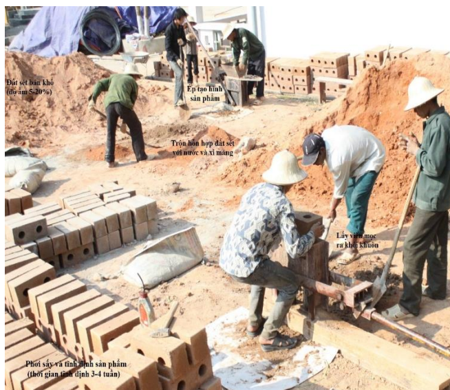
Hình 3. Công nghệ sản xuất gạch đất sét không nung tại công trường
