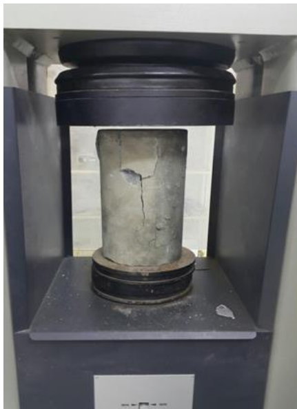
Hình 3. Mẫu BTXMTB hình trụ bị phá hủy sau khi nén đơn trục (sử dụng thiết bị ADVANCEDTEST 9)
