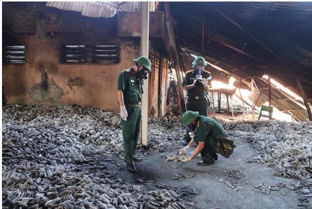
Hình 3. Các cán bộ của Viện Hóa học môi trường quân sự (Bình chủng Hoá học) lấy mẫu tại khu vực cháy kho Nhà máy Rạng Đông về phân tích chỉ số ô nhiễm [8].
